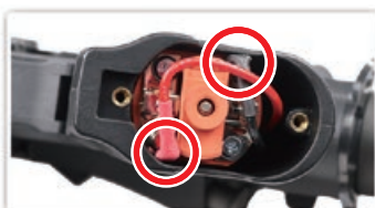
無作動 檢查馬達連接線(需卸下底板)。
