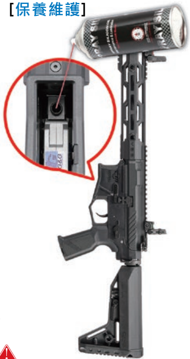
將通槍條插入內管，旋轉通槍條帶出髒汙，重複以上步驟直到內管清潔。
