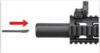
將HOP下壓撥回釋放位置，由槍管前端插入通槍條。
