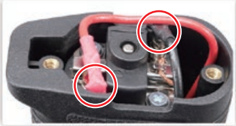
無作動 檢查馬達連接線(需卸下底板)。
