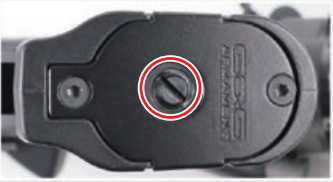
如齒輪發出尖銳聲響 請使用螺絲起子調整握把底部螺絲。
